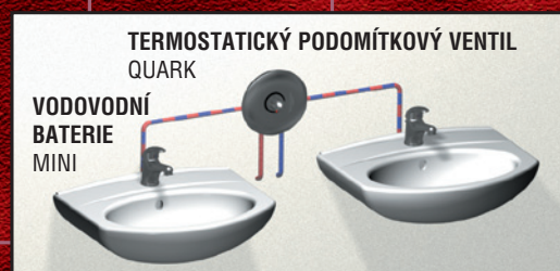
5. Termostatický podomítkový ventil, stojánková baterie pouze na studenou (míchanou) vodu
