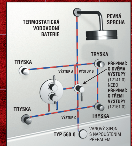
8. Termostatická podomítková baterie Tower Tech, pevná sprcha, přepínací ventil.
