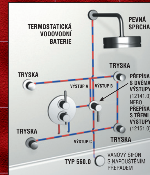
8. Termostatická podomítková baterie Tower Tech, pevná sprcha, přepínací ventil.
