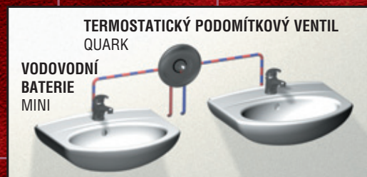
5. Termostatický podomítkový ventil, stojánková baterie pouze na studenou (míchanou) vodu
