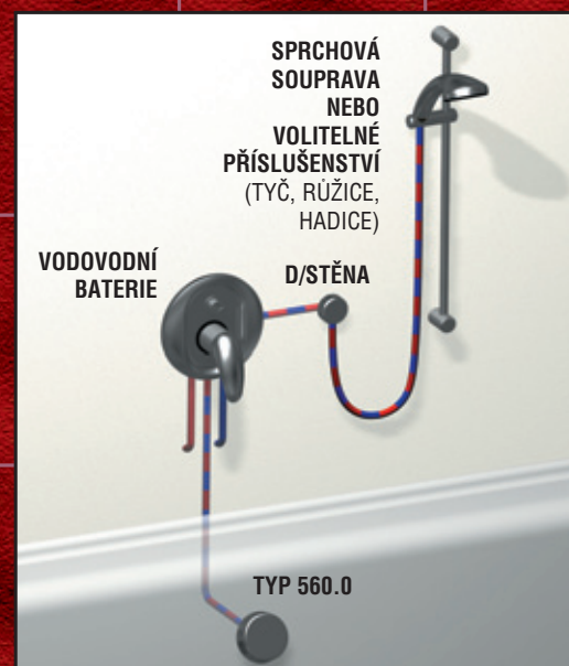
4. Podomítková baterie s přepínačem, sprchový vývod, sprchová souprava, vanový sifon s napouštěním přepadem.
